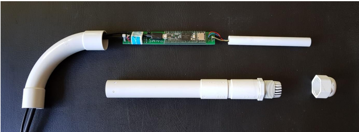
Abbildung 32 Teensy und Mikrofon vorbereitet für Montage
