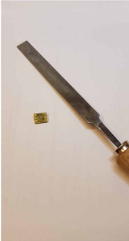
Abbildung 21 Abfeilen der Ecken am Pesky Board
