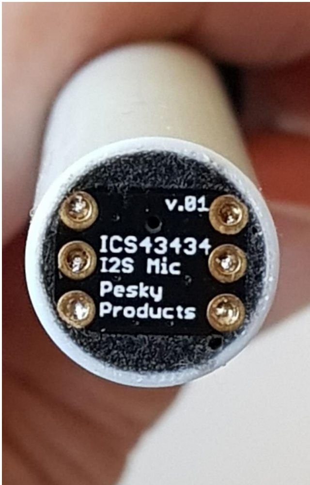
Abbildung 27 fertig ausgegossenes Mikrofonrohr
