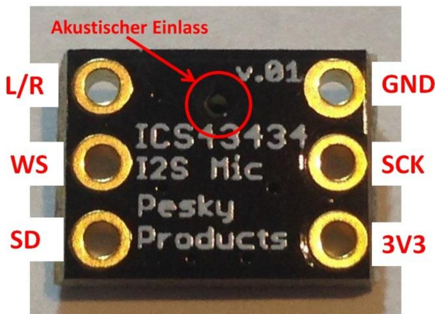
Abbildung 18 Pesky Board akustischer Einlass unbestückte Seite
