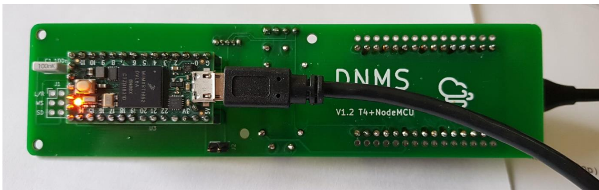
Abbildung 13 DNMS - T4+NodeMCU V1.2 PCB Frontseite
