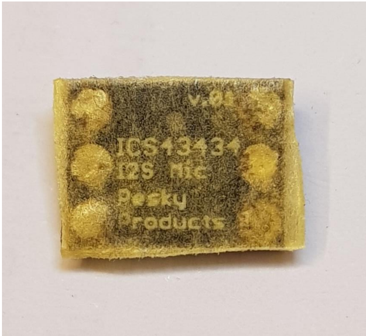
Abbildung 19 Pesky Board mit Kreppband gegen Staub geschützt
