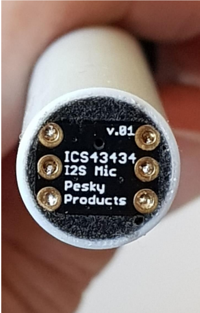
Abbildung 26 fertig ausgegossenes Mikrofonrohr
