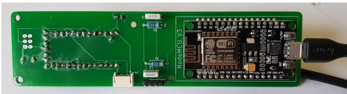
Abbildung 14 DNMS - T4+NodeMCU V1.2 Rückseite
