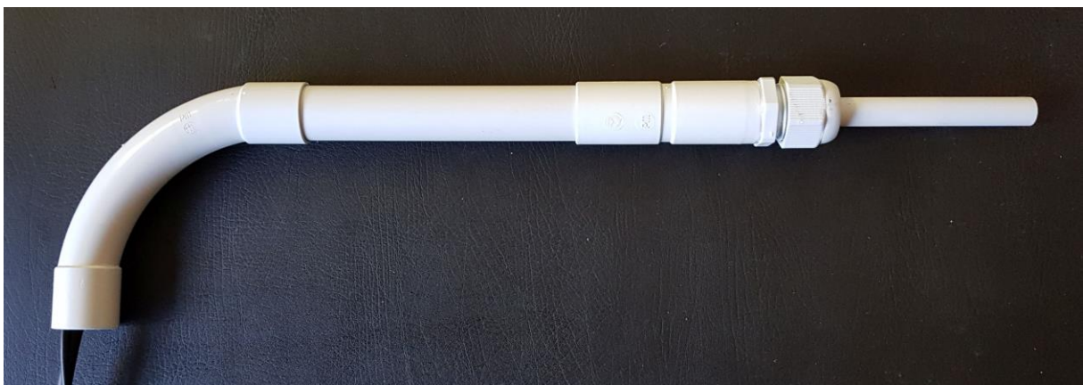
Abbildung 33 fertig montiertes DNMS
