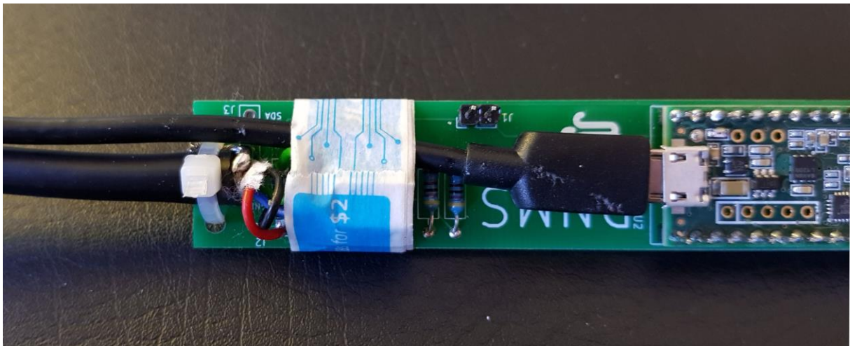
Abbildung 30 USB-Kabel vom Teensy Board mit Klebeband fixiert
